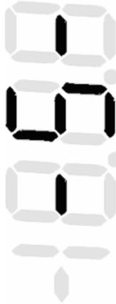
图 9 LCD 显示 样气浓度设置
