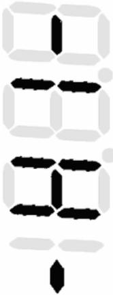
图 12 LCD 显示 高限报警点
